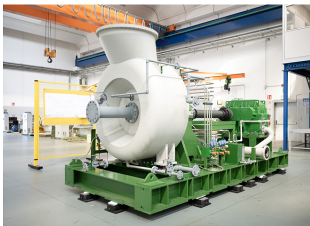
Turbina da 2 MWe di Exergy, applicata su impianto a biomassa
